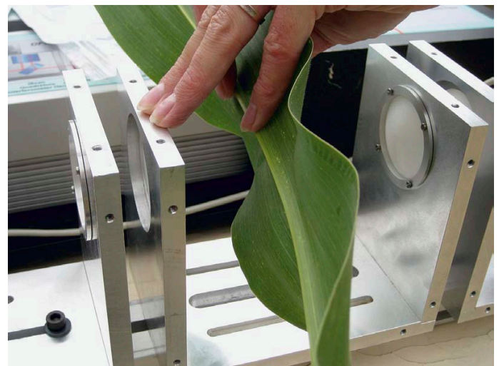
Bild 3: Pflanzenblatt zwischen den Kunststofflinsen des Terahertz-Messaufbaus
